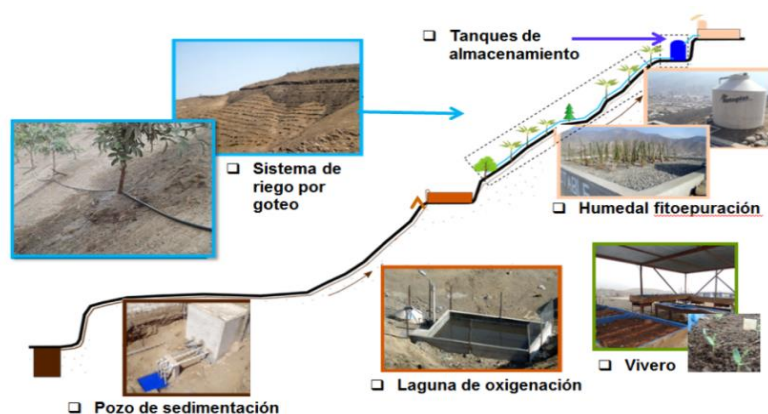
Figura 20. Sistema de tratamiento de aguas residuales en el Instituto Trentino Juan Pablo II ( Los Custodios de la Creación, s.f. ).
